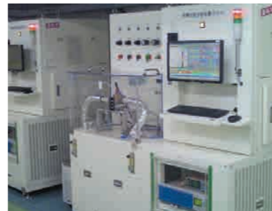
燃料電池 発電性能評価設備 Fuel cell test station
