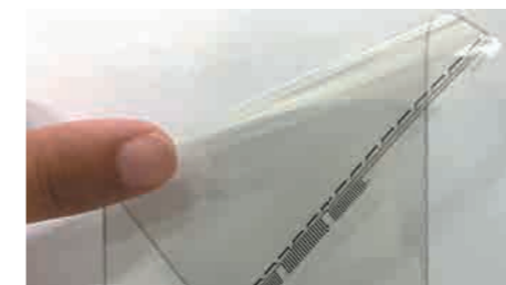
■レイブリッド®を用いたフレキシブルタッチセンサーパネル 従来の電極に比べて①低抵抗、②優れた視認性、③良好な屈曲性、などの特徴を持ち、従来にないフレキシブル電極として注目されています。 Flexible touch sensor panel utilizing RAYBRID™ Compared with the existing electrode, this panel has features such as 1) low resistance, 2) excellent visibility, 3) good flexibility, and is focused as an unprecedented flexible electrode.
