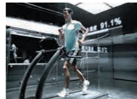
人工気象室における着用試験 Wear testing in climate chamber
